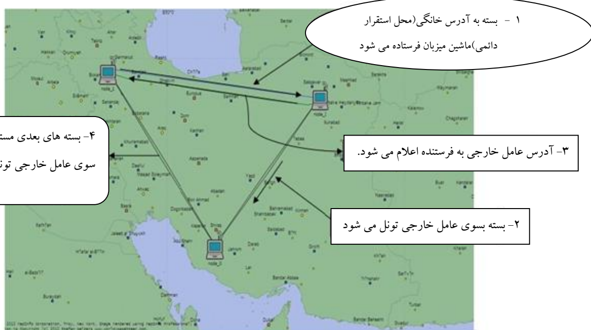
شکل ۳-۶ مسیریابی بسته ها بسوی ماشین های متحرک
