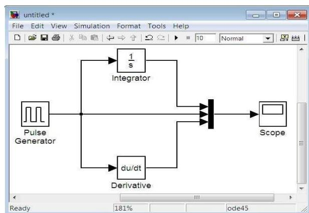
حالا مدل شما آماده شده و می‌توانید اون رو اجرا کنید البته قبل از اجرا کردن باید تنظیمات شبیه‌سازی (زمان اجرا، گام حرکت، نوع حلگر و ...) رو انجام بدید که فعلا برای این مثال نیازی نیست پس مدلتون رو با فشاردادن دگمه استارت، ران کنید سپس به روی اسکوپ دوبار کلیک کنید شما قاعده‌تا باید شکل موجهای زیر رو ببینید:
