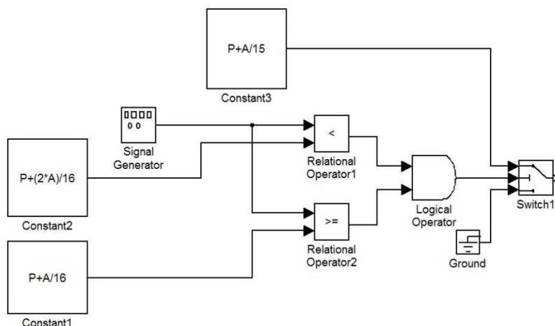
در این شکل همانطور که ملاحظه میشود، زمانی که دامنه سیگنال ورودی از مقدار  $P+(2*A)/16$  کوچکتر و بزرگتر و یا مساوی مقدار  $P+A/16$  باشد، خروجی بلوک AND یک شده و بلوک سوئیچ مقدار  $P+A/15$  را از خود عبور میدهد و در دیگر حالات زمین در مسیر خروجی قرار می‌گیرد.
