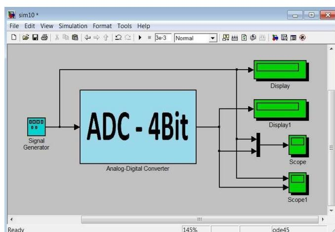
حال مدل را بهازای یک ورودی سینوسی با فرکانس  $1\text{ KHz}$  و مقدار  $\text{dc}$  برابر  $0$  شبیه سازی میکنیم (مقدار مینیمم سیگнал  $-1$  و دامنه پیک تا پیک آن برابر  $2$  است): خروجی بصورت زیر است:
