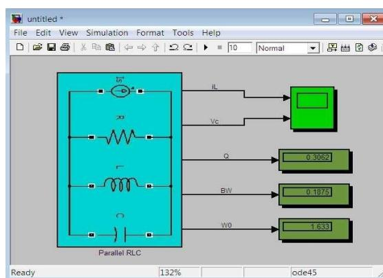
برای دیدن شکل موج ها به روی اسکوپ دوبار کلیک کرده و دگمه Autoscale را بفشارید:
