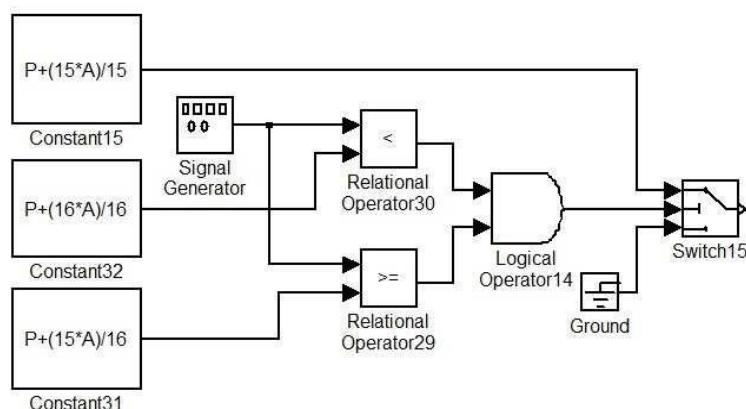
نکته: میتوان یک سیگنال ژنراتور و یک زمین ب ۰ کار برد و برای استفاده در مکانهای دیگر از آنها انشعاب گرفت(درافعه هی چگونه اثر بارگذاری روی یکدیگر ندارند)
