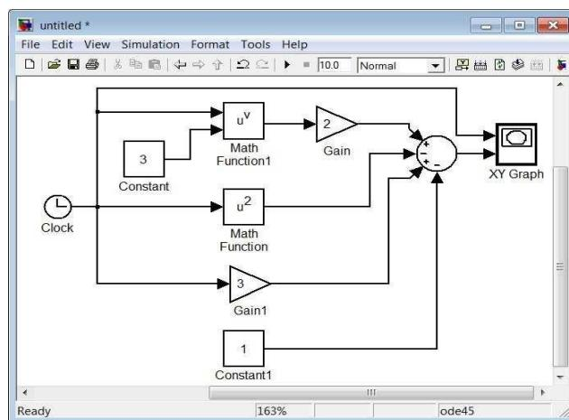
این کلاکی که میبینید در واقع همان زمان شبیهسازی شماست که اینجا نقش متغیر  $X$  را بازی میکند و از این جهت است که به اولین ورودی بلوک XY Graph (محور افقی صفحه مختصات) وصل شده است خروجی جمع کننده نیز برابر با متغیر  $y$  است که به دومین ورودی بلوک XY Graph (محور عمودی صفحه مختصات) وصل شده است نقش باقی بلوکها را اگر به صورت معادله توجه کنید خواهید فهمید.
