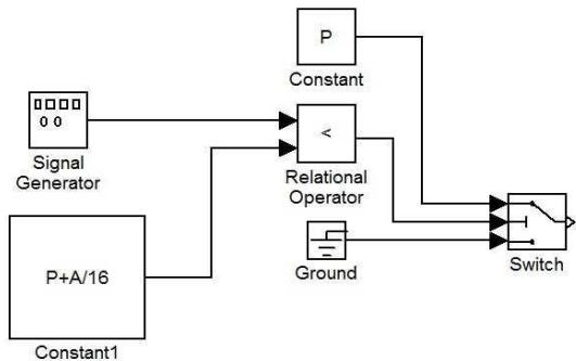
زمانی که خروجی بلوک عملگر رابطه‌ای ، ۱ باشد(دامنه سیگنال از مقدار  $P+A/16$  کمتر باشد) بلوک سوئیچ، عدد  $P$  (مقدار اولیه) و در غیر این صورت این بلوک مقدار صفر را عبور میدهد.
