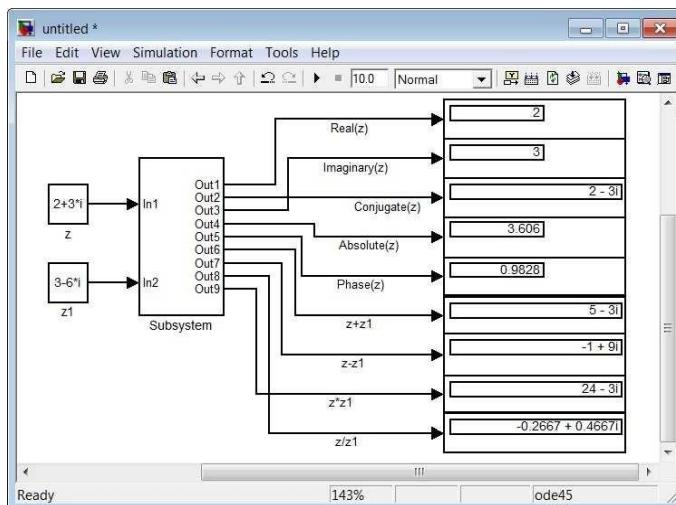
در این مثال با نحوی ایجاد زیرسیستم آشنا شدید شما می توانید زیر سیستمهای مختلفی در یک مدل(حتی زیرسیستمهای تودرتو) ایجاد کنید زیرسیستمهای را معمولا برای مدلها پیچیده و شلوغ به کار میبرند و با دوبار کلیک کردن به روی هر کدام از آنها، محتویات آن مشاهده خواهد شد.
