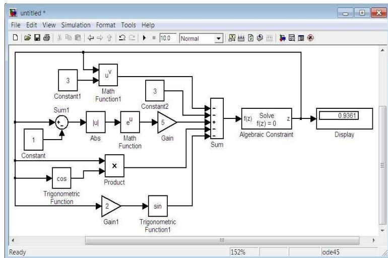
توجه کنید که ورودی بلوک **Constraint Algebraic** تابع و خروجی آن مقداری است که به ازای آن تابع ورودی صفر خواهد شد و به همین دلیل است که از خروجی این بلوک برای تغذیه آرگومانهای تابع ورودی استفاده شده است.
