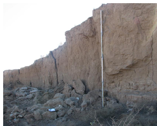
شکل 2- تخریب طاق‌های آویزان تشکیل شده در سواحل رودخانه کردان: (راست) پس از وقوع سیلاب مورخ 22 اسفند 1386 (بده پیک سیلاب در ایستگاه نجم آباد 12/15 مترمکعب در ثانیه)، (چپ) هنگام وقوع سیلاب مورخ 10 اردیبهشت 1388 (بده پیک با دوره بازگشت دو ساله معادل 18/4 مترمکعب در ثانیه)
