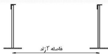
شکل ۸-۲- فاصله‌ی آزاد بین تیرچه‌های فولادی
