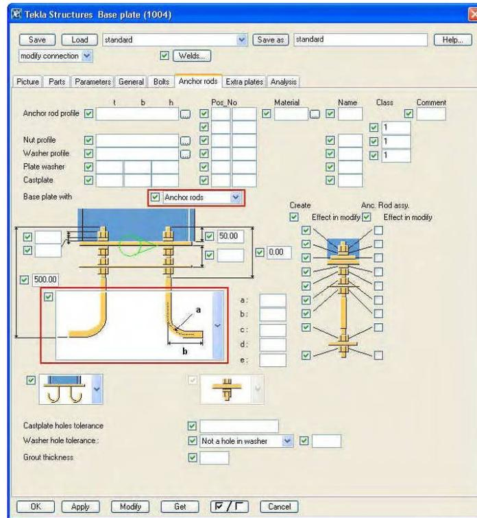
۴- دکمه Modify را بزنید تا پیچها به میل مار تبدیل شوند.
