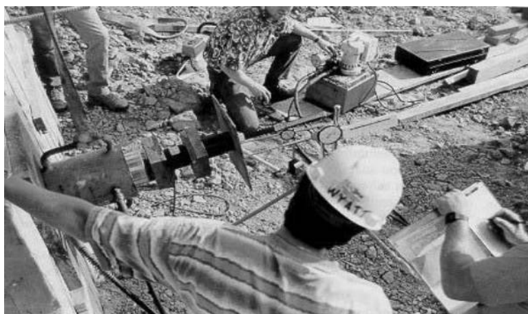
شکل ۱-۸: دستگاه آزمایش بار میخ
