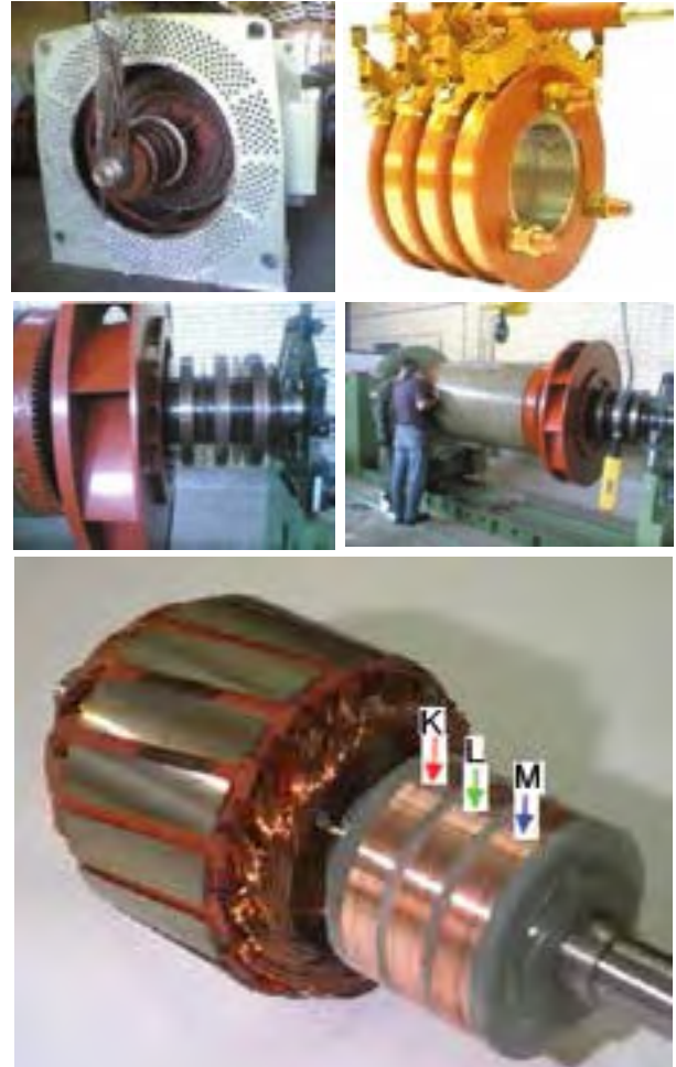
شکل ۸- رتور سیم پیچی شده در ابعاد مختلف
