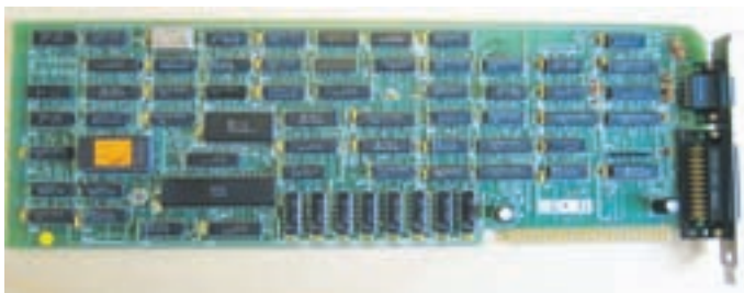
شکل ۵-۳ کارت آداپتور تک رنگ (MDA)
