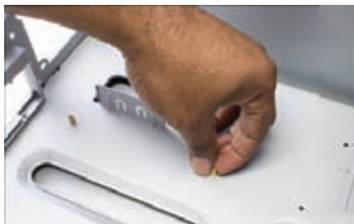
شکل ۸-۱۲ ثابت کردن پایه‌های برنجی
