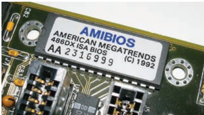
شکل ۲۵-۴ نوعی بایاس روی حافظه ی فلش
