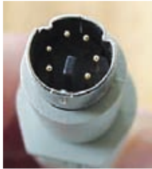
شکل ۱۲-۲ اتصال دهنده‌ی PS/2، سر کابل صفحه کلید
