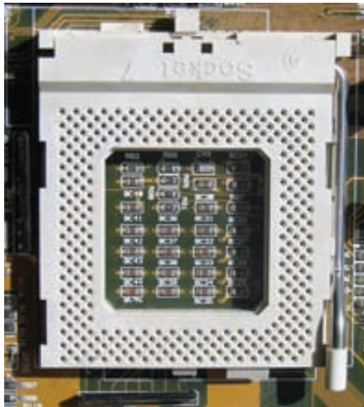
شکل ۲-۷ سوکت پردازنده از نوع ZIF
