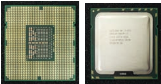
شکل ۴۲-۳ جلو و پشت پردازنده‌ی Intel core i7-975
