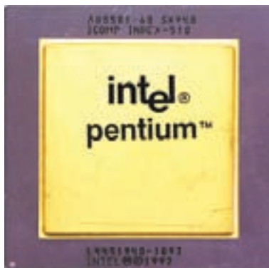
شکل ۳-۲۸ پردازنده‌ی ۸۰۵۸۶ معروف به پنتیوم محصول شرکت اینتل با فرکانس پالس ساعت ۶۶ مگاهرتز و سوکت شماره‌ی ۴
