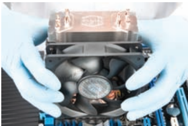
شکل ۸-۹ نصب خنک‌کننده‌ی پردازنده
