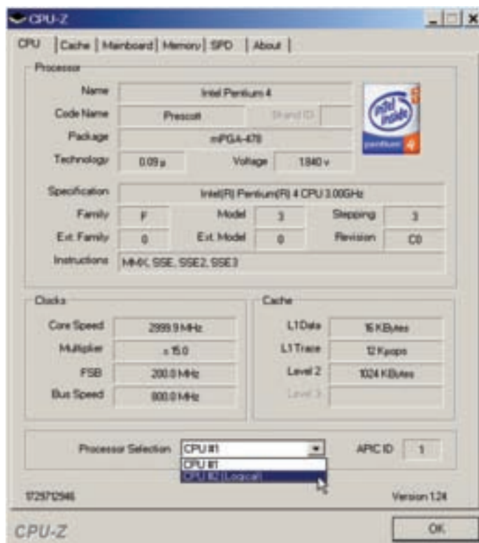
شکل ۶-۳ نمایش مشخصات پردازنده با نرم افزار CPU-Z
