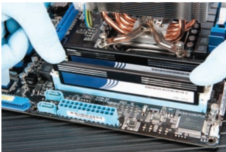
شکل ۸-۱۱ استقرار ماژول حافظه در شکاف حافظه
