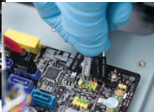
شکل ۱۹-۸ نصب و اتصال کانکتورهای پانل جلوی کیس
