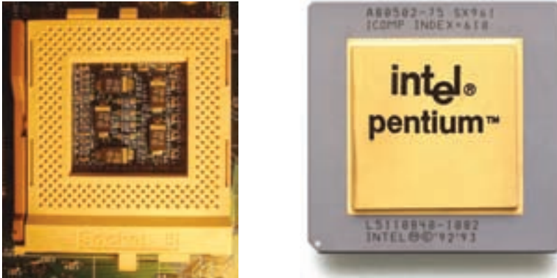
شکل ۳۰-۳ پردازنده ی پنتیوم ۷۵ و سوکت شماری ۵
