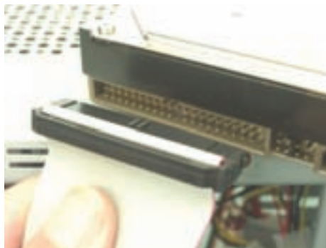
شکل ۸-۲۲ نصب کابل IDE
