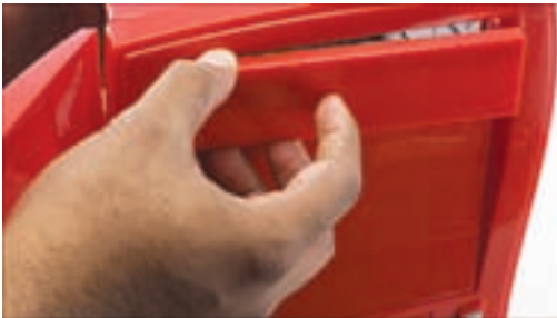
شکل ۲۰-۸ برداشتن پانل جلوی کیس
