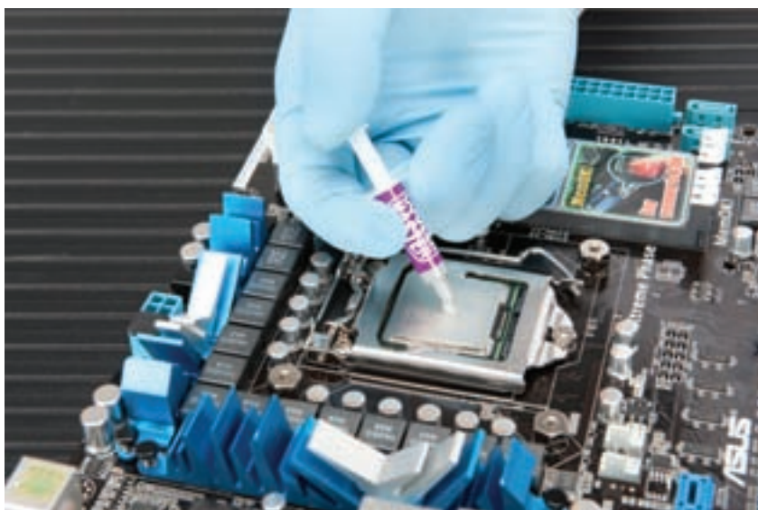
شکل ۸-۷ پوشاندن پردازنده با خمیر انتقال حرارت
