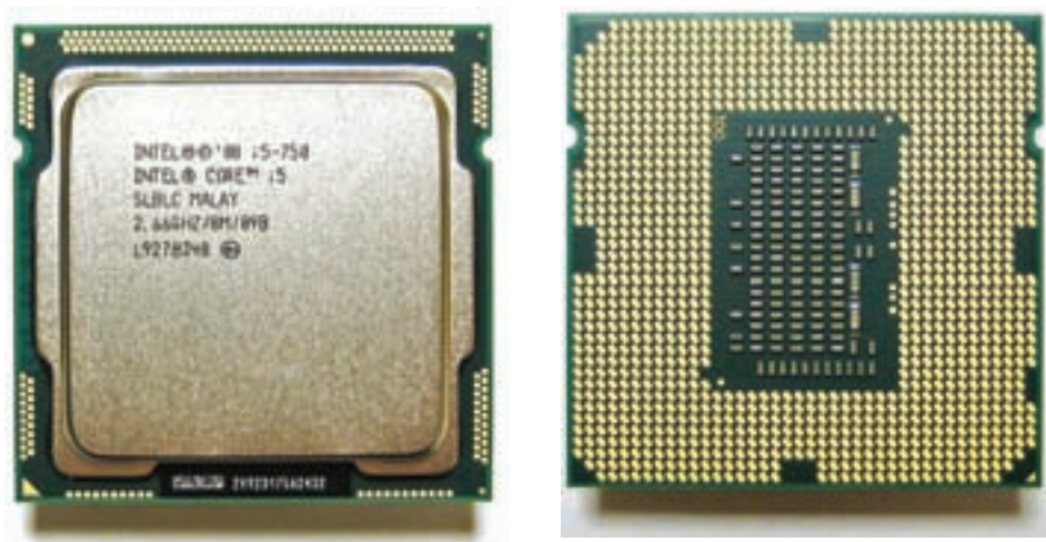
شکل ۳-۴۵ جلو و پشت پردازنده‌ی Intel Core i5-750
