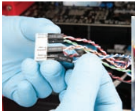
شکل ۱۹-۸ نصب و اتصال کانکتورهای پانل جلوی کیس
