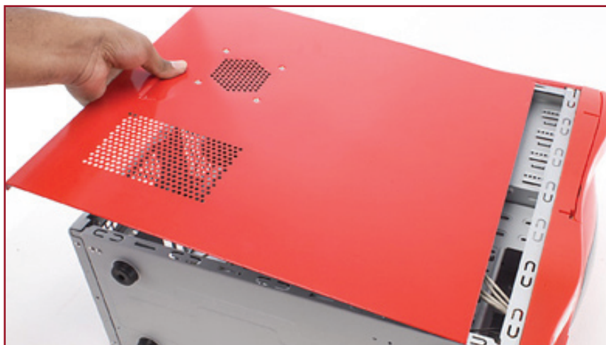
شکل ۸-۱ برداشتن قاب‌های جانبی
