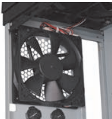
شکل ۳-۸ نصب پروانه‌ی خنک‌کننده‌ی کیس
