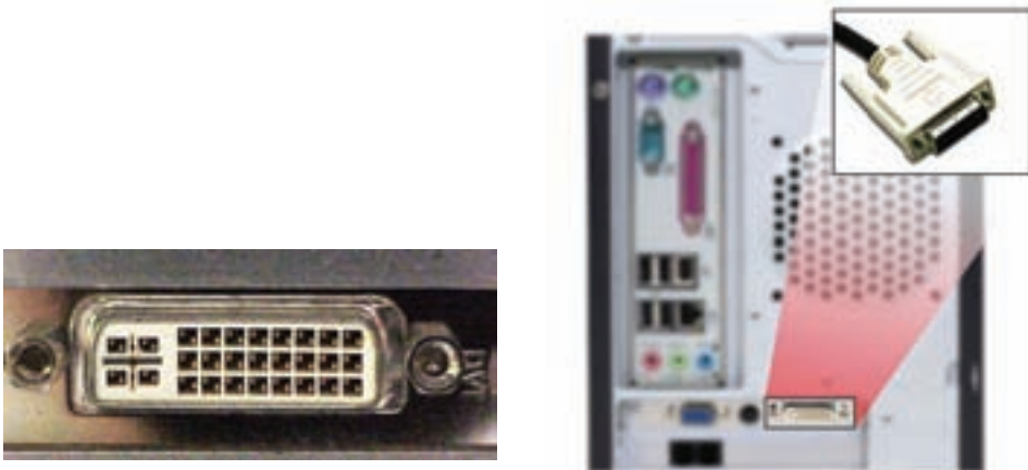
شکل ۵-۱۷ درگاه DVI برای اتصال به صفحه‌نمایش‌های دیجیتال
