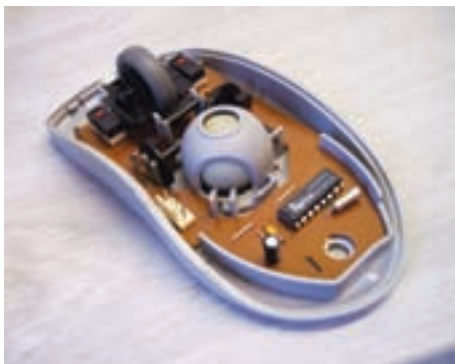
شکل ۲۷-۶ درون ماوس مکانیکی - نوری
