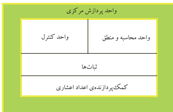
شکل ۸-۱ بخش‌های واحد پردازش مرکزی
