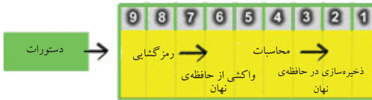
شکل ۱۵-۳ پردازش با استفاده از خط لوله
