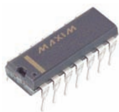
شکل ۹-۴ نوعی حافظه ی DIP که روی برد اصلی لحیم می شدند.
