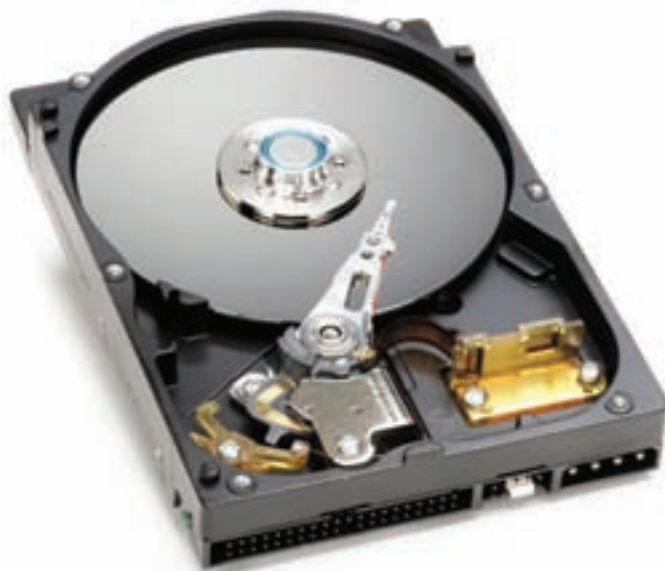
شکل ۲۹-۴ نمای داخلی دیسک سخت
