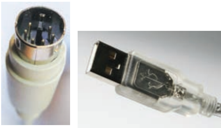
شکل ۲۲- ۶ سمت راست، رابط USB و سمت چپ، رابط DIN شش پین یا PS/2
