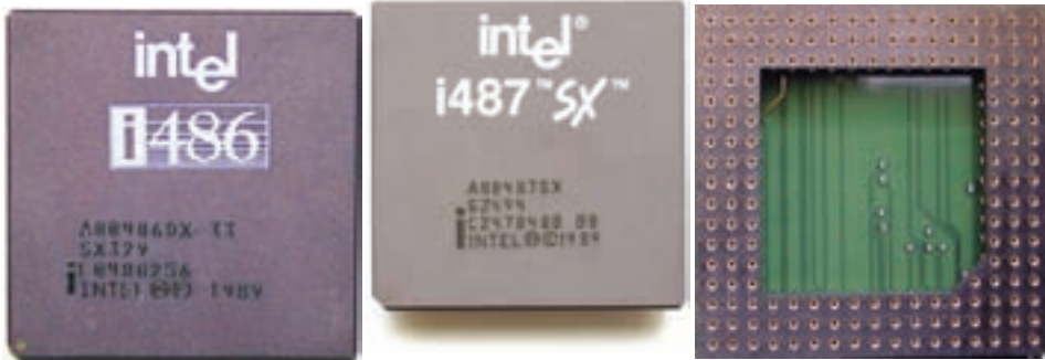
شکل ۳-۲۲ پردازنده ی ۸۰۴۸۶ DX محصول شرکت اینتل با فرکانس پالس ساعت ۳۳ مگاهرتز، کمک پردازنده ی اولیه ی ۸۰۴۸۷ و سوکت شماری یک
