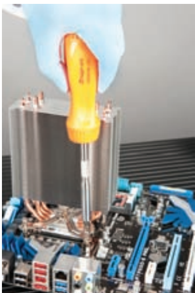
شکل ۸-۸ نمونه‌ای از نصب پایه‌ی خنک‌کننده
