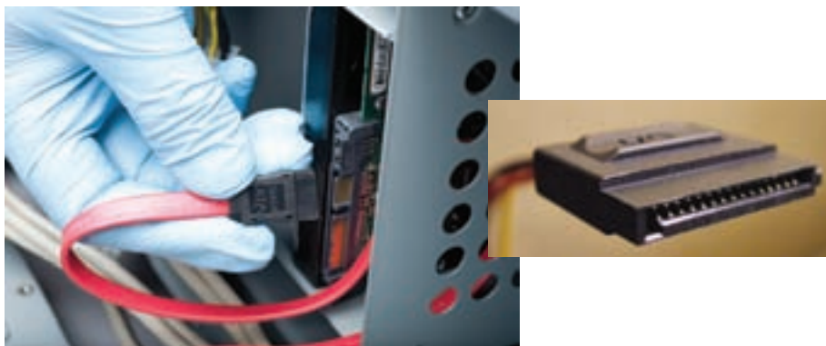
شکل ۸-۲۴ کابل برق و کابل انتقال داده‌های SATA و روش اتصال آن
