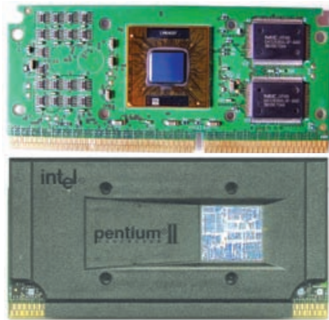
شکل ۳-۳ پشت و جلو پردازنده‌ی پنتیوم II با دو تراشه‌ی حافظه‌ی نهان و به صورت شکاف ۱
