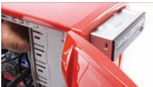
شکل ۸-۲۱ استقرار دیسک گردان نوری
