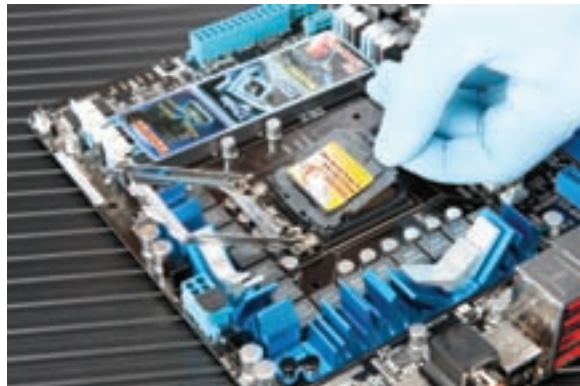
شکل ۸-۴ برداشتن پوشش محافظ سوکت پردازنده
