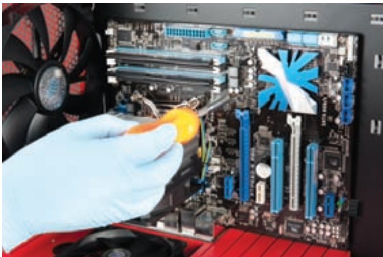
شکل ۸-۱۵ بستن پیچ‌های برد اصلی
