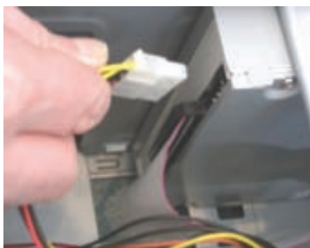
شکل ۲۳-۸ اتصال کابل برق دیسک گردان نوری
