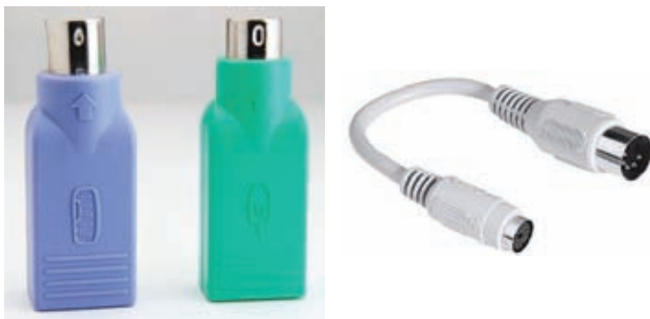
شکل ۲۳- ۶ سمت راست، تبدیل کننده ی DIN پنج پین به PS/2 و سمت چپ، تبدیل کننده ی رابط USB به رابط
