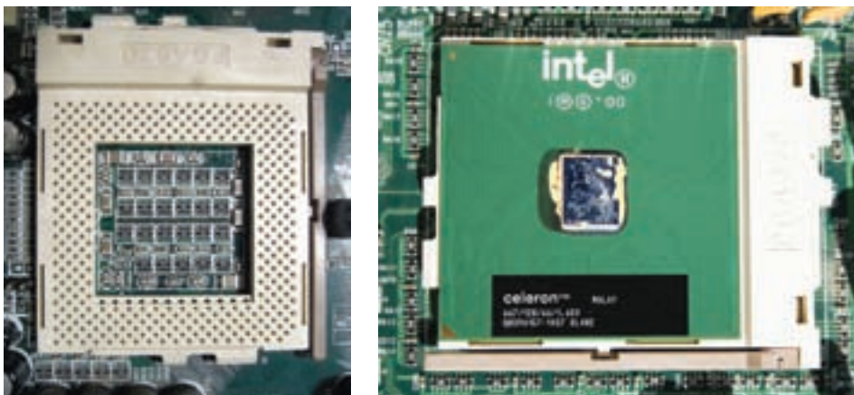
شکل ۳-۳۴ پردازنده‌ی سلرون و سوکت ۳۷۰ PGA
