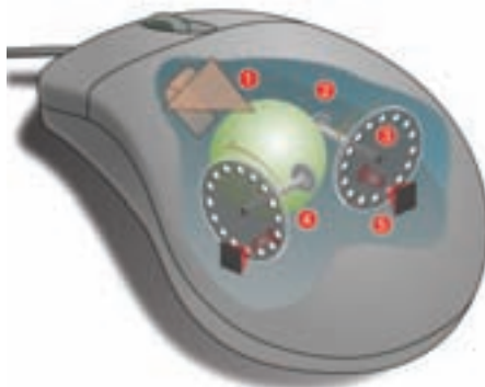
شکل ۲۷-۶ درون ماوس مکانیکی - نوری
