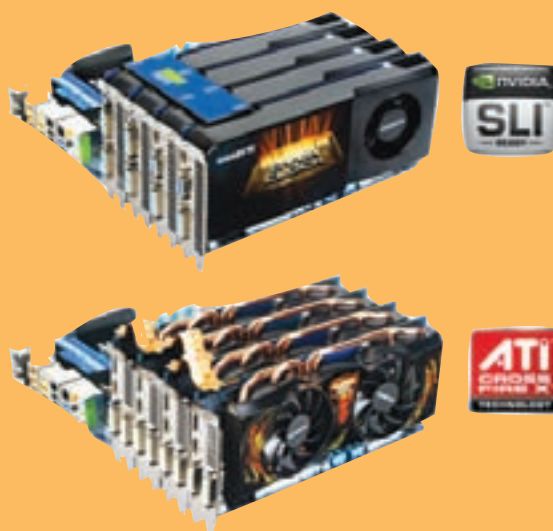
شکل ۸-۲۵ نصب کارت‌های گرافیک CrossFire و SLI
