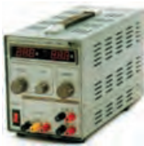
منبع تغذیه‌ی الکترونیکی با نشان دهنده‌ی هفت قطعه‌ای
