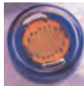
شکل ۱۴-۱- نمای ظاهری و علامت اختصاری یک فتورزیستور
