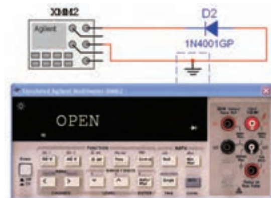
شکل ۲-۲۲ آزمایش دیود در بایاس مخالف
