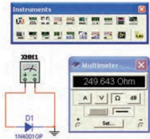
شکل ۲-۱۶ مقاومت دیود در بایاس موافق
