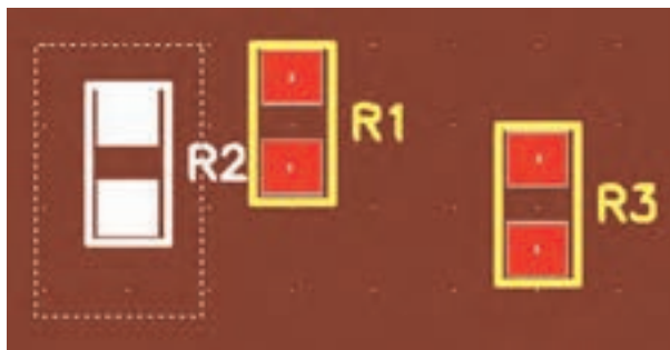
شکل ۳-۱۹ انتقال مقاومت روی فیبر مدار چاپی
