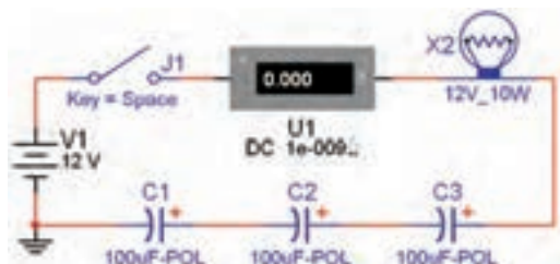
شکل ۸-۵ جریان عبوری از مدار خازن‌های سری
