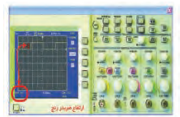
شکل ۲-۱۰۳ اندازه‌گیری ولتاژ پیک تا پیک
