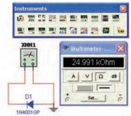
شکل ۲-۱۷ مقاومت دیود در بایاس مخالف
