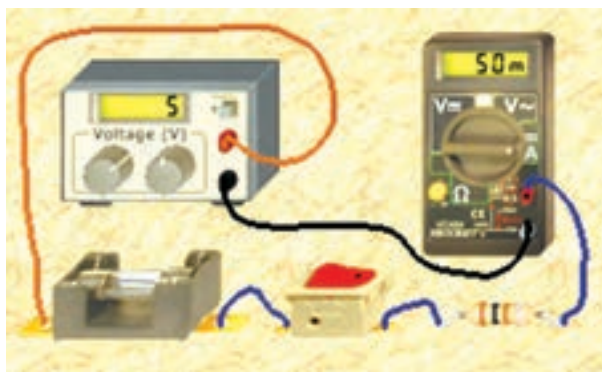
شکل ۱-۳ اندازه‌گیری جریان در یک مدار ساده با استفاده از قانون اهم
