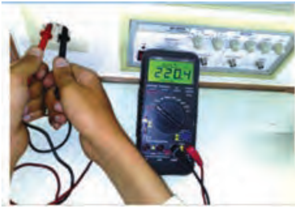
شکل ۲-۷۹ اندازه‌گیری ولتاژ برق شهر
