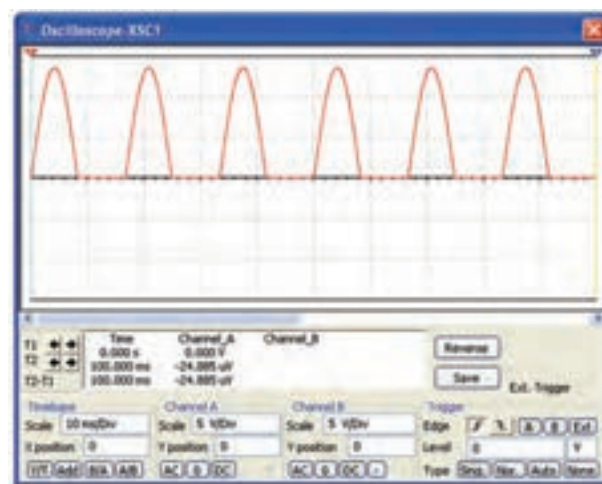
شکل ۳-۴ مدار و شکل موج یکسوساز نیم موج
