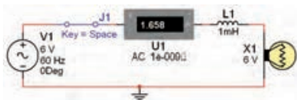
شکل ۷-۱۶ بررسی اثر تغییر فرکانس روی مدار AC شامل سلف و لامپ
