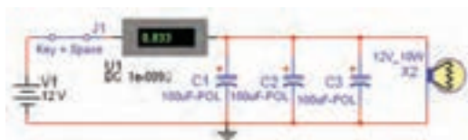
شکل ۸-۶ جریان عبوری از مدار خازن‌های موازی
