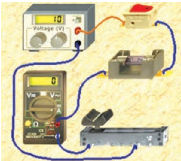
شکل ۱-۱۳ در مدار پتانسیومتر فیوز سوخته است.
