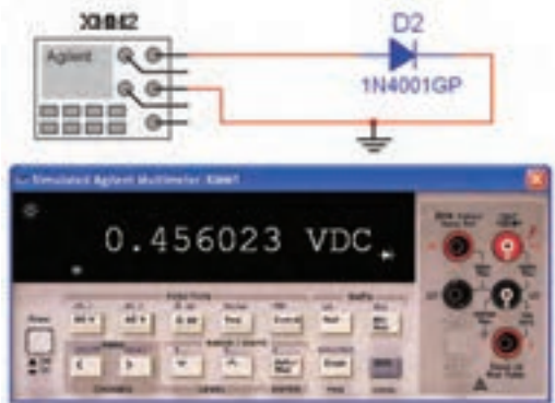
شکل ۲-۲۱ آزمایش دیدود در بایاس موافق
