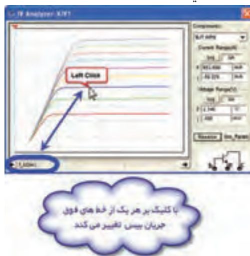
شکل ۱۳۳-۲ الف منحنی مشخصه‌ی ترانزیستور
