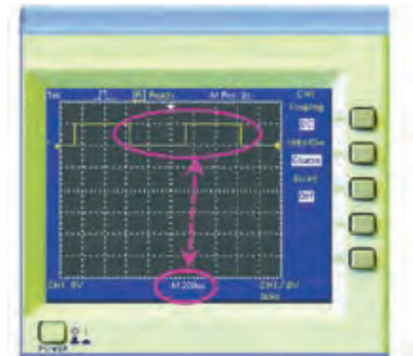
شکل ۱۰۵-۲ اندازه‌گیری زمان تناوب موج مربعی
