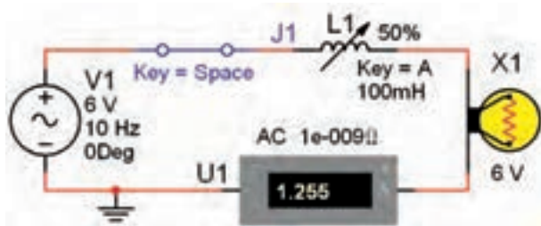
شکل ۷-۱۵ بررسی اثر تغییر مقدار سلف در مدار با منبع AC
