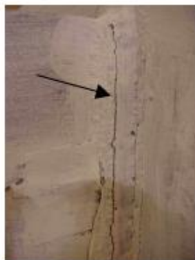
شکل ۱۴: گسیختگی در HAZ در اتصال تیر-ستون، تست شماره ۳
