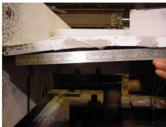
شکل ۱۱: دررفت جانبی طبقه- نیروی جانبی، تست شماره ۲
