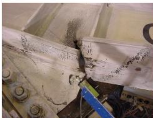
شکل ۱۵: گسیختگی در تیر در انتهای ورق پشت بند، دررفت ۲,۶٪، تست شماره ۳
